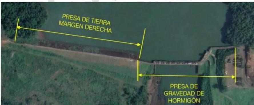
La presa de gravedad de hormigón tiene una longitud de 381,00 m al nivel del coronamiento y una altura máxima de 41,00 m desde el nivel más bajo de fundación.
